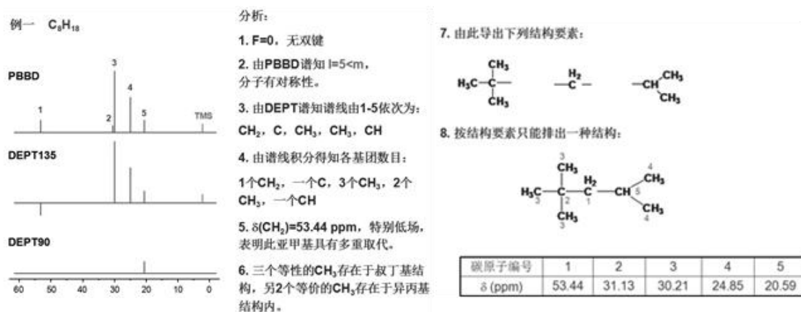
图 5.6 \text{C}_8\text{H}_{18} 一维 ^{13}\text{C} 解析实例
