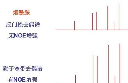
图 5.4 烟酰胺反转门控去耦和质子宽带去耦 ^{13}\text{C} 谱比较
